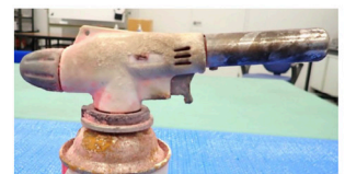
ガストーチの異常燃焼
